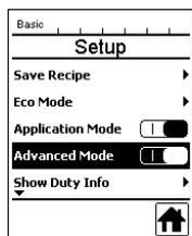
Dans le réglage de base, vous arrivez par le menu « Setup » à l'enregistrement de l'instruction, à la fonction Standby (« Mode Éco ») ainsi qu'à l'Advanced Mode.
