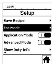
Si le moteur est coupé, le chauffage activé et si aucune touche n'est actionnée pendant le temps défini sous l'intervalle du « mode Éco », l'appareil commute automatiquement dans l'affichage veille. Si, au cours des 180 sec. qui suivent, la touche « e-Drive » (31) n'est pas actionnée, le chauffage passe en mode Cool down. « Standby » (Mode de veille) apparaît ensuite sur l'écran. Si la touche « e-Drive » (31) est actionnée, la commutation se fait en mode de travail.
