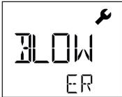
Dès que l'intervalle de maintenance de l'appareil est atteint, « BLOWER » ou « DRIVE » apparaît après l'affichage de démarrage. L'affichage disparaît automatiquement après 10 sec. ou peut être confirmé par un appui sur la **touche de confirmation (42)**. L'appareil doit impérativement être porté au centre de service.
