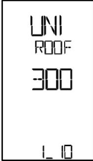
Après la connexion, l'écran de démarrage s'affiche brièvement sur l'écran de l'**unité de commande (2)** avec le **numéro de version** de la version actuelle du logiciel et de la désignation de l'appareil.
