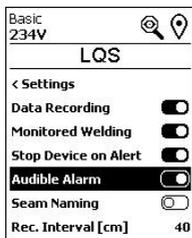
Si l'option Alarme sonore est activée, une alarme sonore retentit lorsque la valeur limite est dépassée.
